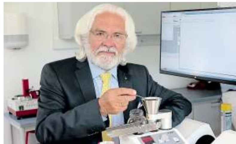
Stephan Rötthele löst eine Zement-Probeprobe in das Trockendispersier- und -dispersiersystem.
